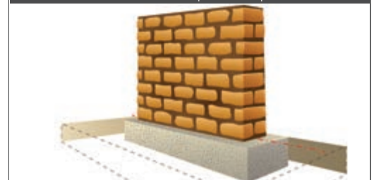
Achèvement de la base en béton armé des deux côtés le long du mur
