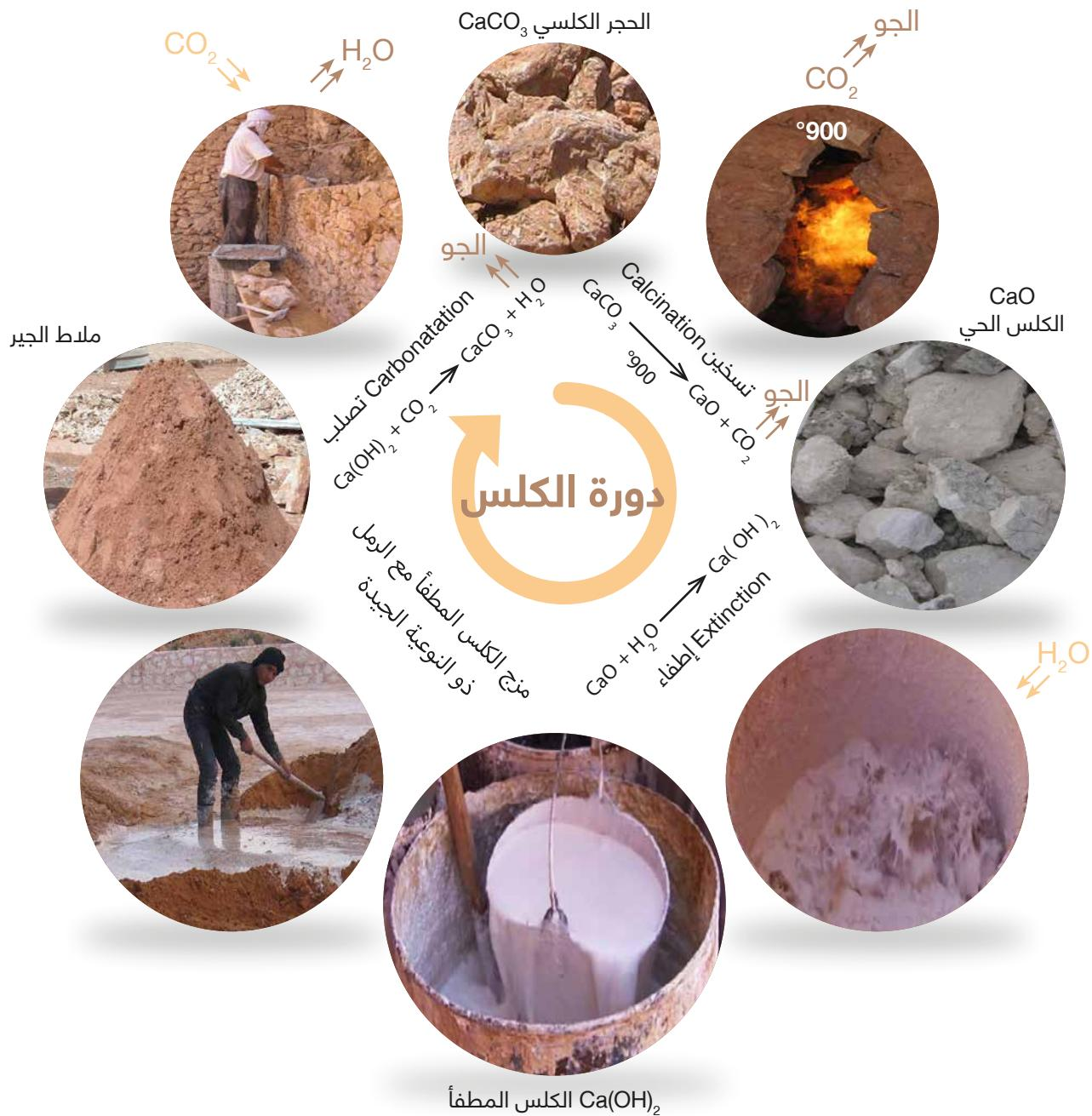
الكلس الحي  $\text{CaO}$  أو أكسيد الكالسيوم لا يمكن استعماله مباشرة في عملية البناء لأن امتزاجه بالماء يؤدي إلى انتفاخات لا يمكن السماح بها في أية منشأة أو بناية. يجب إذن القيام بعملية تمييه للكلس الحي  $\text{CaO}$  و تحويله إلى كلس مطفأ  $\text{Ca(OH)}_2$  و الذي يدعى بهيدروكسيد الكالسيوم بعد إضافة الماء، هذا الأخير يظهر على شكل بودرة بيضاء قليلة الذوبان في الماء.
