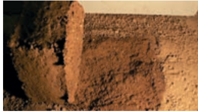
التصاق اللبن بالأرض لعدم إضافة مادة مانعة للاتصاق كالرمل أو الرمد
