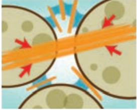
إضافة ألياف نباتية لتثبيت قالب الطين
